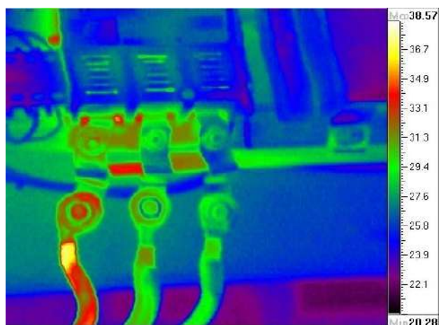
Рисунок 21. Пример термограммы контактных соединений с температурной шкалой
