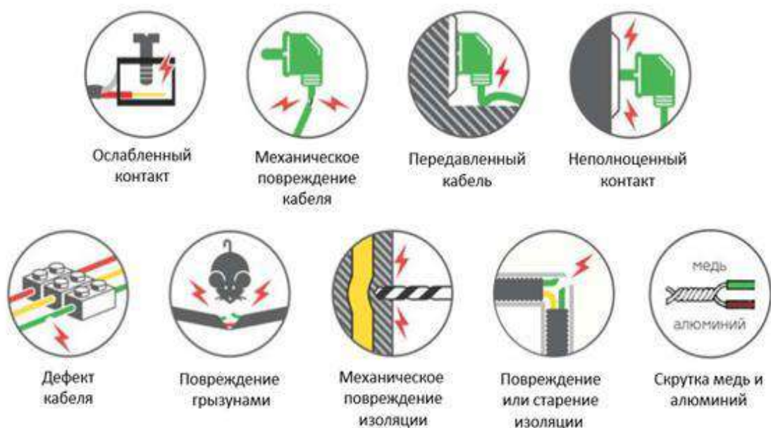
Рисунок 6. Возможные причины искрения в электропроводке
